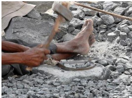
Photo 1 : Exemple d'outils de travail pour concasser les blocs de granite
